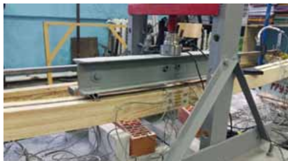
Иллюстрация 7. Разрушение балки БА-2 в ходе эксперимента. Фото авторов: А. В. Есипов, А. И. Бараняк, И. С. Сальный, Я. В. Воробьев
