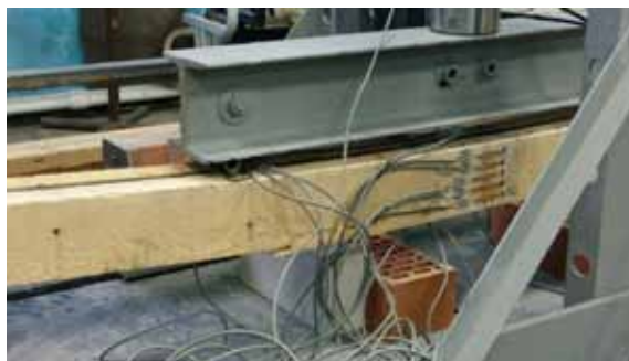
Иллюстрация 6. Разрушение балки БА-1 в ходе эксперимента. Фото авторов: А. В. Есипов, А. И. Бараняк, И. С. Сальный, Я. В. Воробьев
