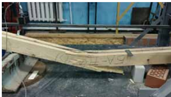
Иллюстрация 8. Разрушение балки БА-3 в ходе эксперимента. Фото авторов: А. В. Есипов, А. И. Бараняк, И. С. Сальный, Я. В. Воробьев
