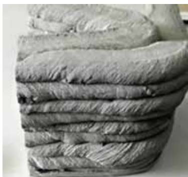
Иллюстрация 8. Внешний вид больших фрагментов стены до разрушения при испытании на сжатие. Фото Д. Н. Галиева. Апрель 2018 г.
