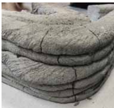
Иллюстрация 9. Характер разрушения шестислойного участка стены при испытании на сжатие. Фото Д. Н. Галиева. Апрель 2018 г.
