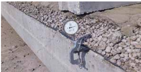
Иллюстрация 3. Схема измерения прогибов плиты в ходе испытания. Фото А. А. Землянского
