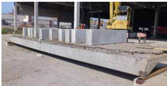
Иллюстрация 2. Последовательность загрузки плит. Фото А. А. Землянского
