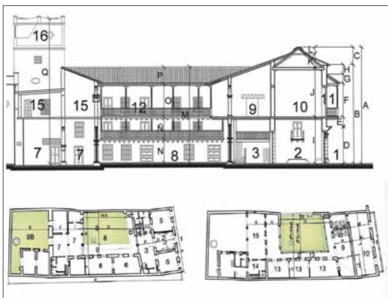
Иллюстрация 8. Большой жилой дом, типичный для архитектуры колониального периода в Колумбии: 1 — вход; 2 — крыльцо; 3 — фойе; 4 — лестница; 5 — внешние помещения; 6, 7 — внутренние помещения; 8 — внутренний дворик; 9 — фойе второго этажа; 10 — большой зал; 11 — балкон; 12 — коридор; 13 — спальня; 14 — кухня; 15 — столовая; 16 — смотровая площадка
