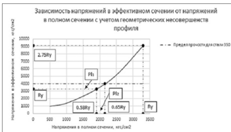
Иллюстрация 8. Зависимость напряжений в эффективном сечении от напряжений в полном сечении с учетом начальных геометрических несовершенств. Авторы: Н. Д. Корсун, Д. А. Простакишина
