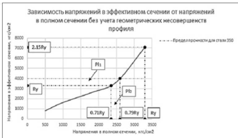
Иллюстрация 7. Зависимость напряжений в эффективном сечении от напряжений в полном сечении без учета начальных геометрических несовершенств. Авторы: Н. Д. Корсун, Д. А. Простакишина
