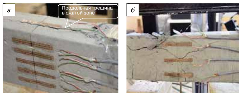
Иллюстрация 3. Характерный вид разрушения сжатой зоны бетона на примере балок: а — Б1–6.1; б — Б4–8.1. Фото М. В. Новикова
