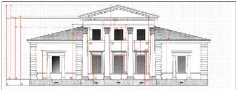
Иллюстрация 2. Пример эвритмической связности линейных размеров элементов фасада с ордерным строем 6 : 5. Вертикальные ординаты. Автор А. В. Долгов
