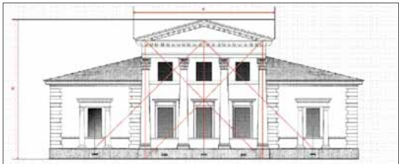
Иллюстрация 4. Схема наиболее очевидных отношений равенства линейных размеров фасада. Автор А. В. Долгов
