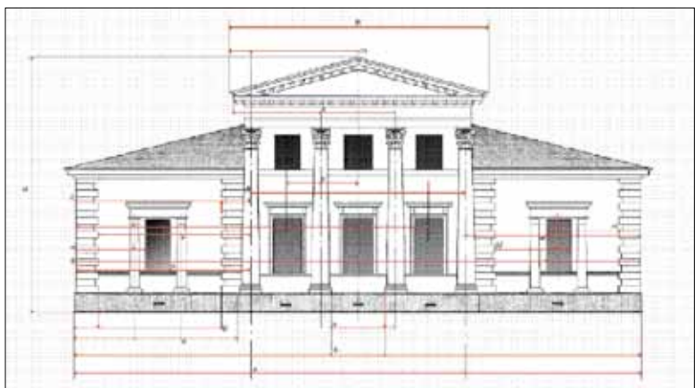
Иллюстрация 3. Пример эвритмической связности линейных размеров элементов фасада с ордерным строем 6 : 5. Горизонтальные ординаты. Автор А. В. Долгов
